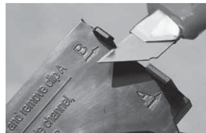
X-deel links en rechts met een mesje afsnijden. Clip B links en rechts met een mesje afsnijden.
