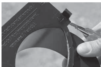
Door het Y-deel uit te snijden wordt een maximale doorstroming verkregen.
